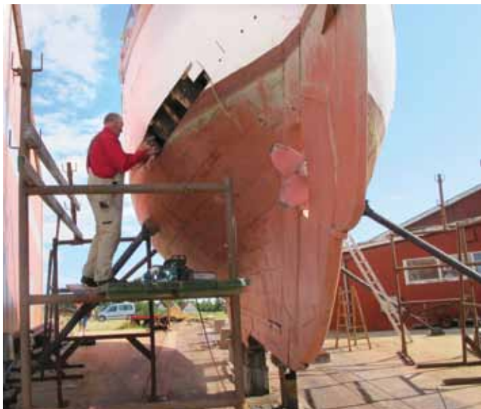
SERVICE: Reparasjonen av «Liv» ble satt i gang umiddelbart etter ulykken. Her skiftes skadete eikebord og deler av kjølen.
